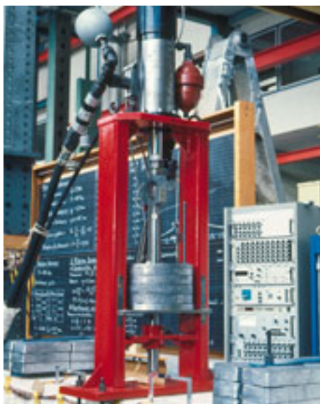
01 Servohydraulischer Schwingungserreger auf einem Stahlbetonbalken
