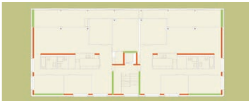
Über die ganze Gebäudehöhe laufende Stahlbetonwände (grün) für die Abtragung der Erdbebenkräfte sowie Mauerwerkswände (rot) und Stahlstützen (blau) zur Abtragung der Schwerelasten.
